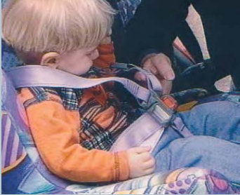
Falsch; zu locker!
