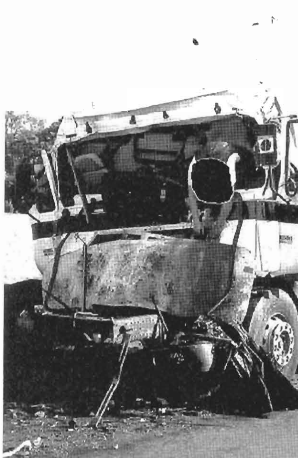
Bild 12▼ Beispiele von Lkw-Kollisionen mit mäßiger Fahrerhausdeformation und Herausschleudern der Lkw-Fahrer
