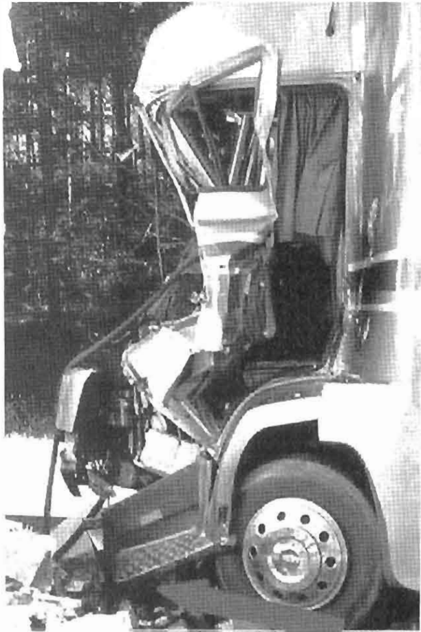
Bild 11▲ Beispiele von Lkw/Lkw-Auffahrunfälle mit erheblicher Fahrerhausdeformation
