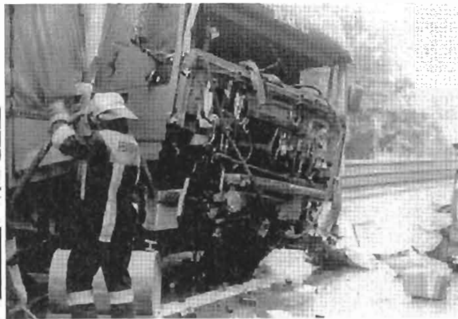
Bild 12▼ Beispiele von Lkw-Kollisionen mit mäßiger Fahrerhausdeformation und Herausschleudern der Lkw-Fahrer
