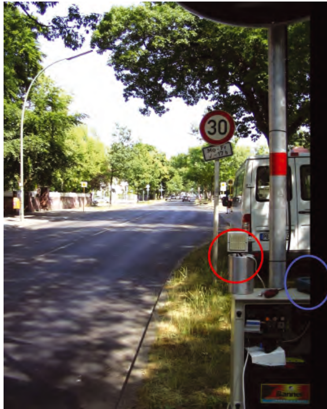
Abbildung 17: Standort Königin-Luise-Straße-B (Messpunkt 232) mit Frontradar (rot)
