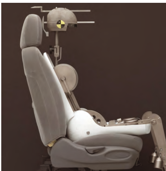
Bild 1: Messeinrichtung für Ermittlung der Kopfstützengeometrie Quelle: IIHS
