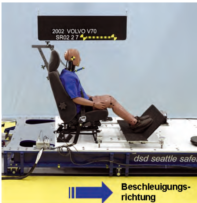
Bild 3: Schlittenaufbau für dynamischen Sitztest Quelle: IIHS
