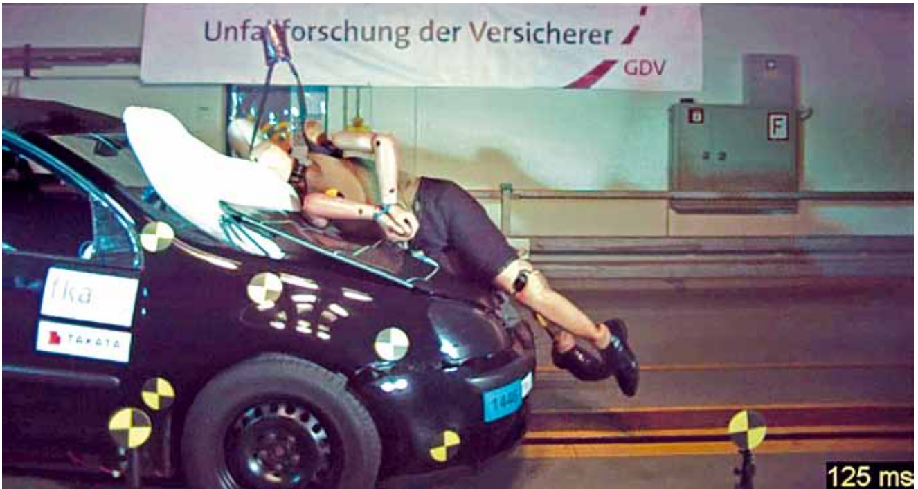
Überprüfung der Wirksamkeit der untersuchten passiven Maßnahmen an einem Fahrzeug bei einem Crashtest mit POLAR-II-Dummy
