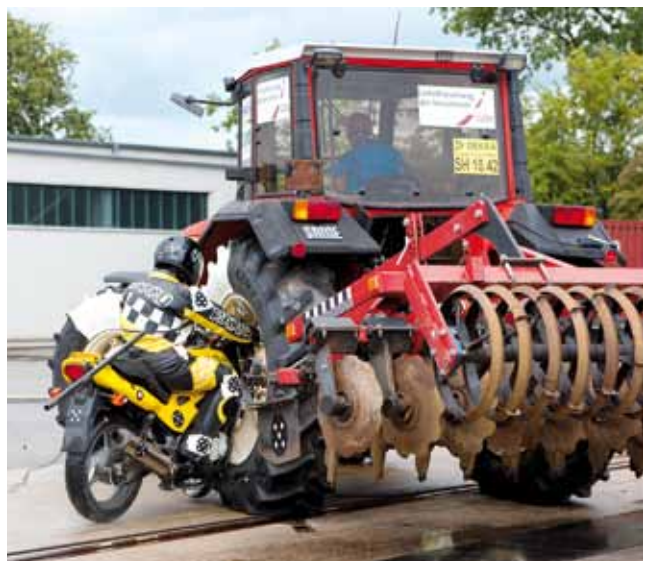
Crashtest-Szenario: Überholendes Motorrad kollidiert bei 70 km/h mit der linken Seite eines abbiegenden Traktors
