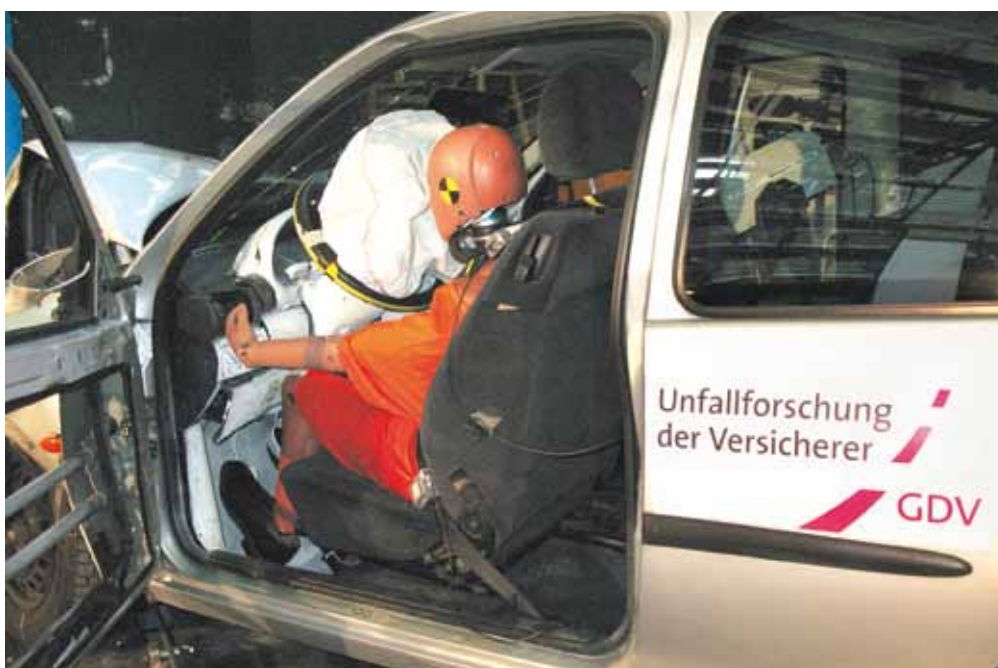
Fahrer in vorgerückter Sitzposition mit Knieanprall bei Frontalaufprallversuch (Instrumententafel modifiziert)
