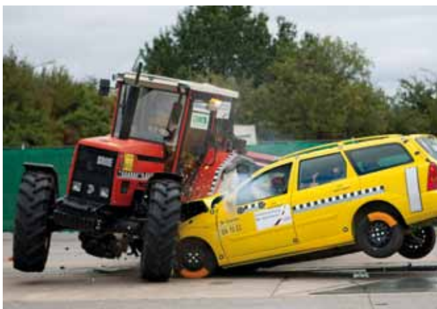
Crashtest: Überholender Pkw trifft mit 75km/h das linke Hinterrad eines abbiegenden Traktors
