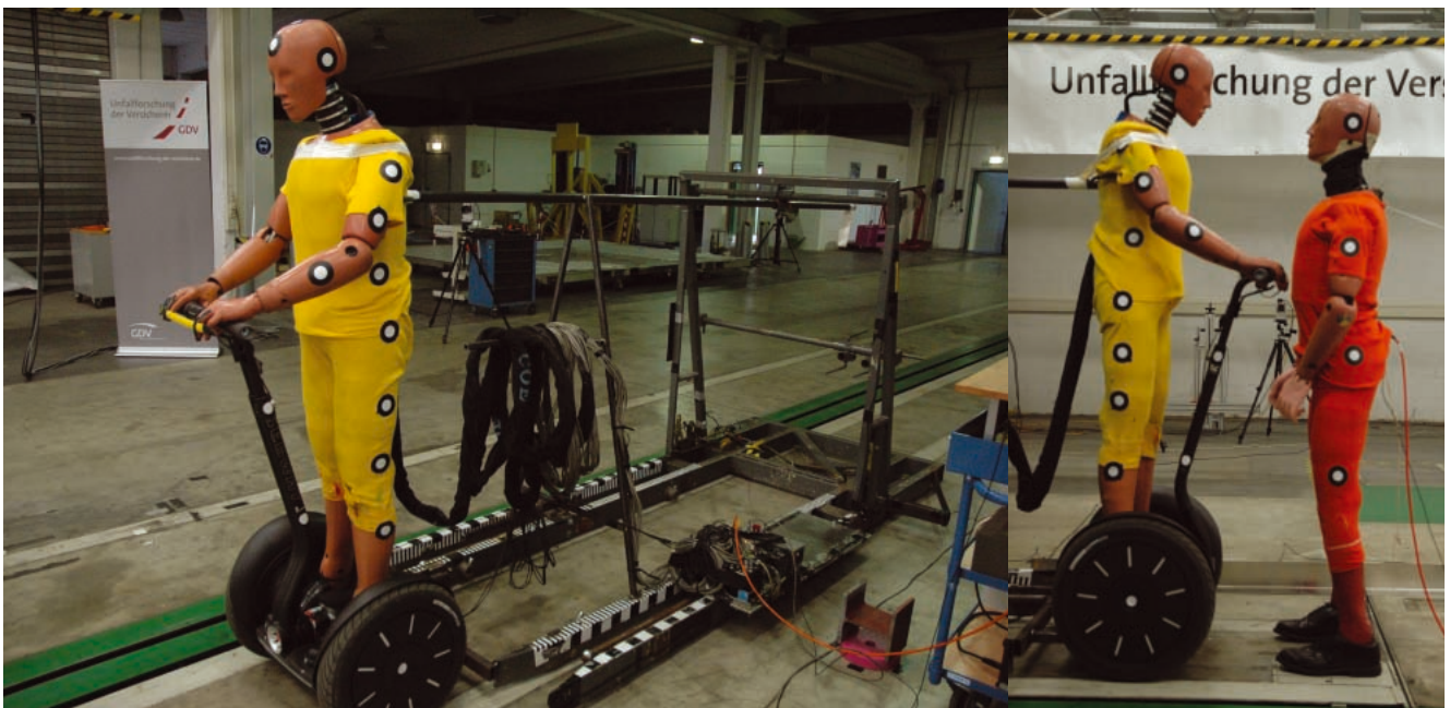
Abbildung 6: Versuchsaufbau (rechts: Stellprobe, links: Beschleunigungsschlitten)
