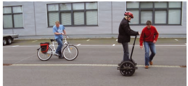
Abbildung 4: Vergleich der Anhaltewege Segway und Fahrrad
