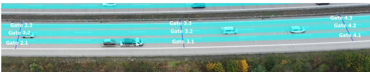
Abbildung 13: Festlegung von Gates in DataFromSky anhand der Trajektorien für jeden Fahrstreifen im Abstand von 54 Metern
