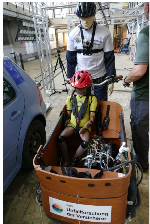
Abbildung 13 · Lastenfahrrad mit Crashtest-Dummys
