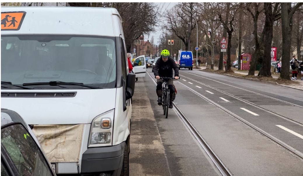
Abbildung 9: Schmale Querschnitte führen oft zu unfallbegünstigender Schienen-nähe (Deutschland)
