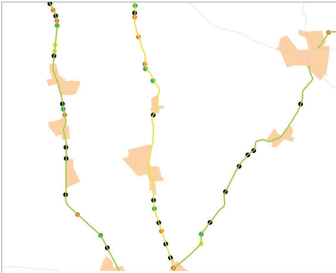
Abbildung 7: Darstellung zur Problematik der Berücksichtigung von Ortsdurchfahrten (Länge der ODs gehen in die Berechnung des SIPOs ein, Unfälle auf OD werden nicht berücksichtigt)
