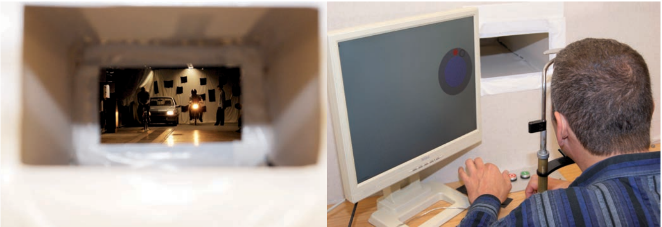
Abbildung 2: Sicht des Probanden auf die Szenerie im Lichtkanal (links) und Position des Probanden mit Nebenaufgabe (rechts)
