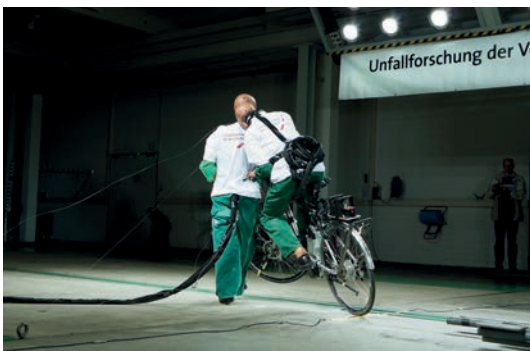
Abbildung 4: Zusammenstoß zwischen Pedelec ( v = 25 \text{ km/h} ) und Fußgänger
