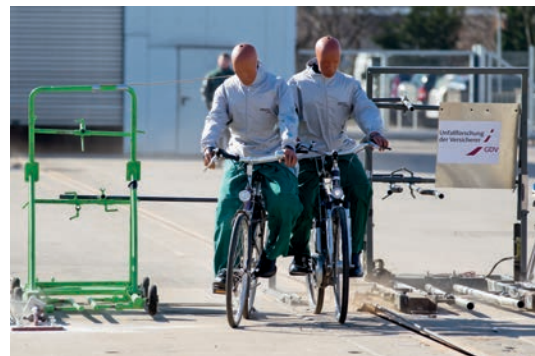
Abbildung 2: Zusammenprall zwischen Fahrrad ( v = 22 \text{ km/h} ) und überholendem Pedelec ( v = 44 \text{ km/h} )
