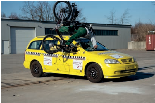
Abbildung 3: Zusammenstoß zwischen stehendem Fahrzeug und in die Seite fahrendem Pedelec ( v = 44 \text{ km/h} )
