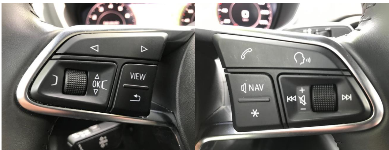
Abbildung 4: Multifunktions-Lenkrad (MFL) und Nahaufnahmen der Bedienelemente
