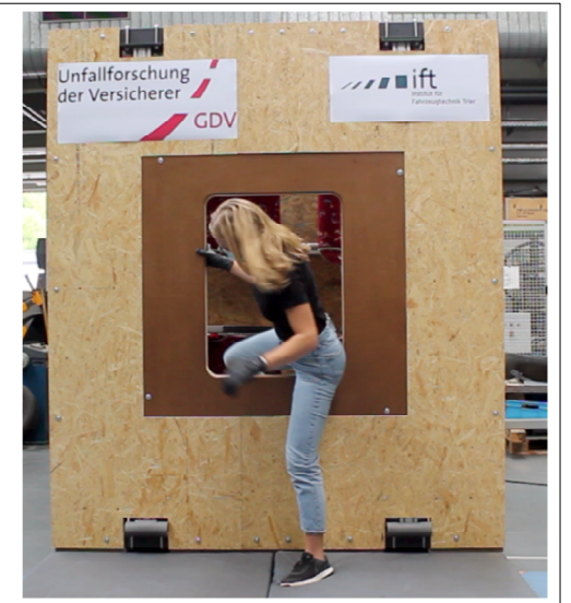
Notluke quer eingebaut
