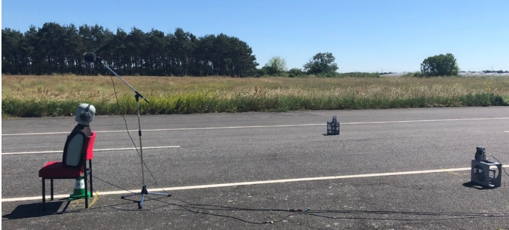
Abbildung 2: Messaufbau an der Teststrecke. An der Referenzposition (links) befinden sich Kunstkopf und Freifeldmikrofon. Rechts daneben ist die Lichtschranke aufgebaut.
