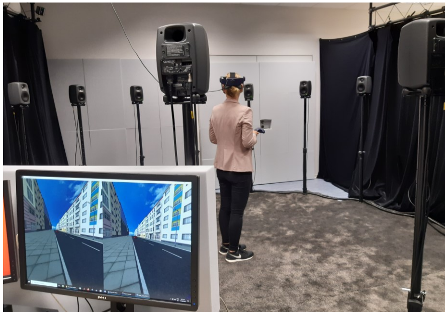
Abbildung 4: Array aus 16 kreisförmig angeordneten Lautsprechern zur auditiven Darbietung des räumlichen Schallfelds im Labor (Ambisonics 7. Ordnung).
